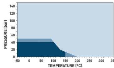
Les diagrammes PT indiquent la combinaison maximale admissible de pression interne et de température de service pouvant être appliquée simultanément à une épaisseur, une taille et une classe d'étanchéité données pour un joint. Compte tenu de la grande variété d'applications et de conditions de service, ces valeurs ne doivent être considérées qu'à titre indicatif pour un assemblage correct. En général, les joints plus fins présentent de meilleures propriétés PT.
